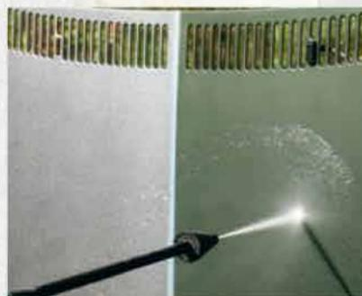
▲ ... und Folie. Hier den Druck unbedingt verringern oder besser von Hand arbeiten, weil sich sonst die Schutzschicht lösen kann
